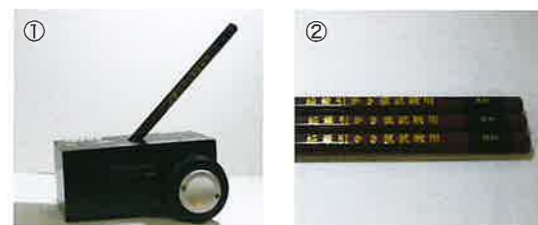
①オールグッド社製JIS規格対応鉛筆硬度試験機 ②一般財団法人日本塗料検査協会試験用鉛筆
