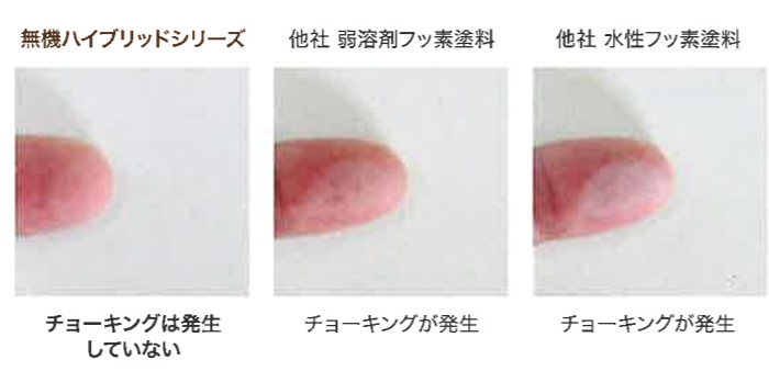
■沖縄県(宮古島)での7年ばく露の試験体比較
