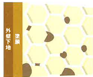
塗膜が緻密でないため、汚れが付着しやすい
