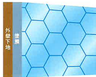
塗膜が緻密で強靱なため、汚れが付着しにくい
