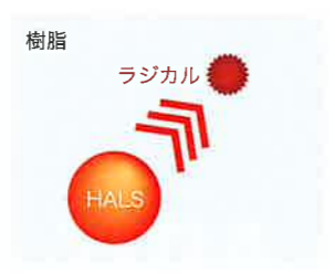
HALSがラジカルを捕捉。ラジカルによる塗膜劣化を抑える。
